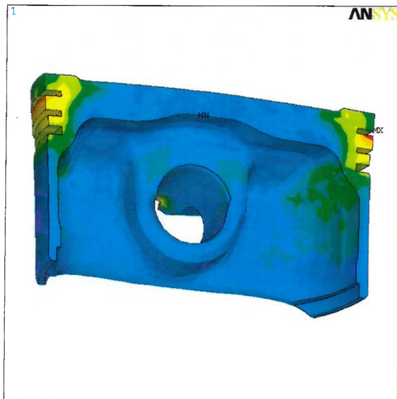
Figura 9: Tensões principais \sigma_1 devido às cargas térmicas
